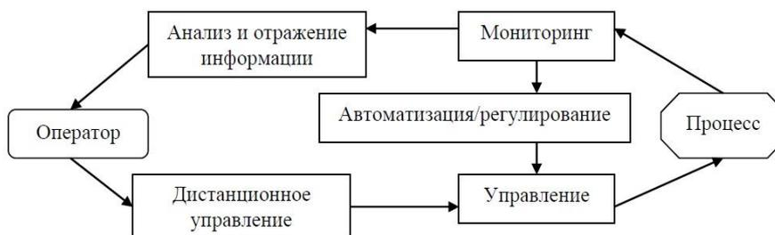
Рис. 1. Функциональная нагрузка SCADA систем
