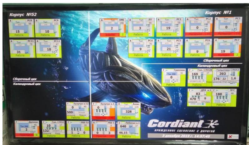
Рис. 3. Вид экрана системы мониторинга работы технологического оборудования
