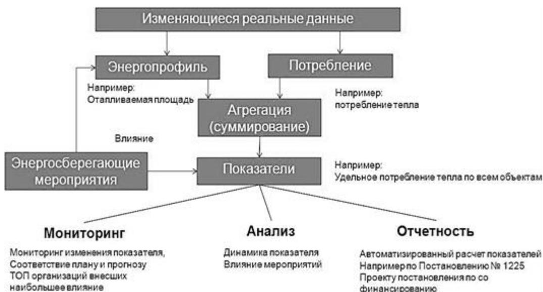
Рис. 4. Модель применяемой системы управления энергозатратами на промышленном предприятии
